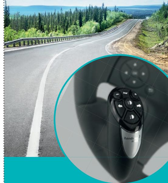
**LENKOK – der Lenkradkombinationsknopf ermöglicht die Bedienung der Funktionen Blinker, Wischer und Licht ohne Loslassen des Lenkrads.**
